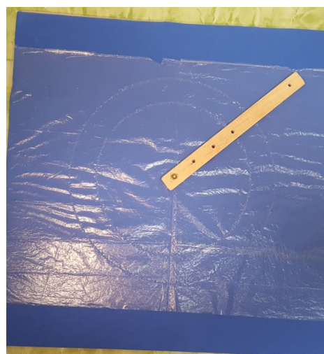
Figura 3.5: Compasso piano adattato ai non vedenti.
