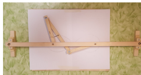
Figura 3.7: Parallelogramma di Watt che disegna una lemniscata.
